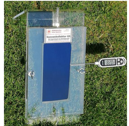
Foto 1 oben: Der Sonnenkollektor GS mit eingeschobenem Einstichthermometer, Anzeige 82°C.
