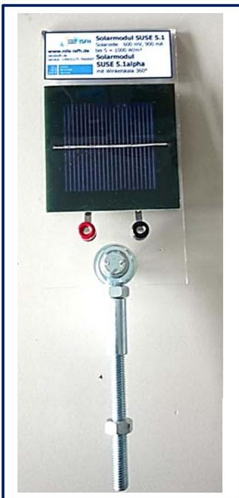
Das **Solarmodul SUSE 5.1** enthält eine hochwertige Solarzelle SUSEmod2 mit  $U_{oc} = 0,61 \text{ V}$  und  $I_{sc} = 0,90 \text{ A}$ , gekapselt und laminiert, sowie zwei 4mm- Messbuchsen rot/schwarz zur Messung von Spannung oder Stromstärke.
