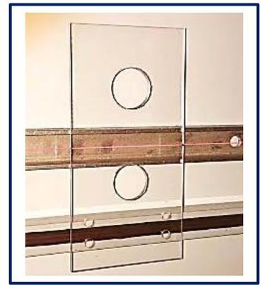
**Oben:** Biegen auf dem Glühdraht- Biegegerät
