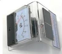
2 Solar- Strahlungsmessgeräte SUSE 4.24A
