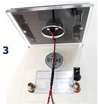
Montage des Solarmoduls und des Schrumpfschlauchs
