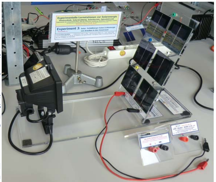
Aufbau des Experiments 3: Auf der Grundplatte SUSE 4.0 befindet sich das Solarmodul SUSE 4.3RB, davor stehen das Speichermodul SUSE 4.12 und das LED- Modul SUSE 4.15
