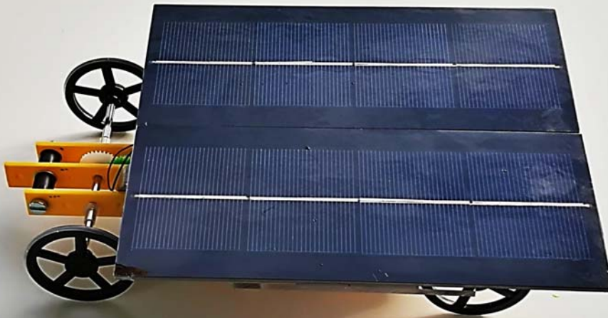
SUSE Solarfahrzeug 7 2 Solarmodule mit 8 Solarzellen
