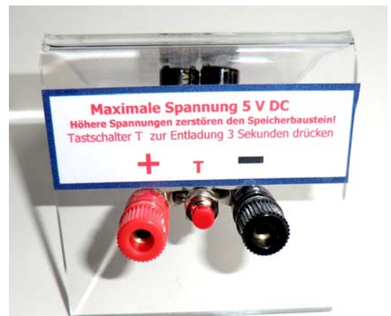
Oben: Das Speichermodul SUSE 4.12 Links die Polklemme + , rechts die Polklemme – zum Anschluss an ein Solarmodul. Der Tastschalter T in der Mitte dient zum Entladen.
