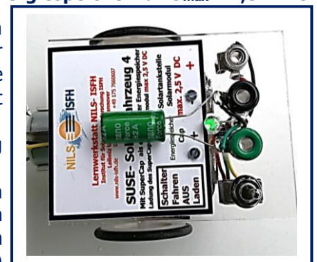
Die grün leuchtende LED zeigt den Ladezustand an, zwischen 75% und 100%.
