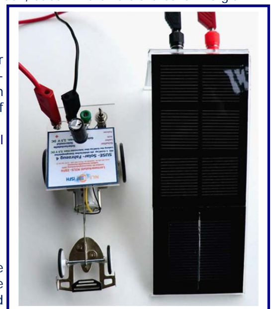
Das Solarfahrzeug 4 mit der Solartankstelle (Solarmodul) SUSE 4.34 (2,4V/ 630 mA)
