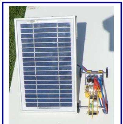
Das Solarfahrzeug 1.2 an der Solartankstelle (Solarmodul SUSE 4.49), ein Solarmodul mit 5,0 V Ausgangsspannung, ideal zum Laden des Solarfahrzeugs
