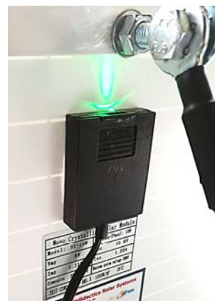
Die grün leuchtende LED an der Anschlussbox zeigt die Betriebsbereitschaft an.
