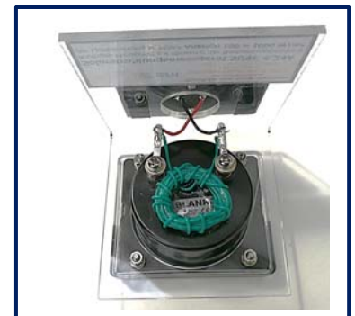
Oben: Die Solarzelle und das Typschild auf der Rückseite Unten: Der Innenraum mit dem Nebenwiderstand (grün).
