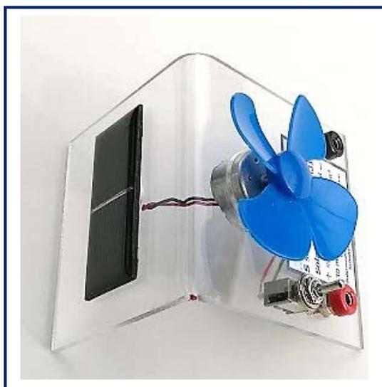
Auf dem dachförmig um 75° gebogenen Modulträger aus Plexiglas (Gesamtmaß 160mm x 80mm x 3mm), erkennt man vorne den Solar- Elektromotor mit dem Propeller, die 2 Anschlussbuchsen rot + schwarz und den Schalter S. Auf der Rückseite befindet sich die hochwertige monokristalline Si-Solarzelle SUSEmod5 (Modulmaße 60mm x 30mm, Solarzelle 52mm x 26mm).
