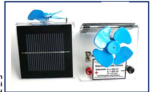
Das Solarmodul SUSE CM6MS Links die Vorderansicht mit der Solarzelle Rechts die Rückseitenansicht mit Buchsen, Schalter, Elektromotor mit Propeller
