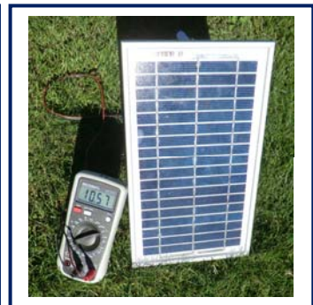
Die Leerlaufspannung im Sonnenlicht: 10,57 V
