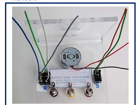
Oben: Die 3 Buchsen und die 2 Schalter (links S2, rechts S1) sind montiert.
