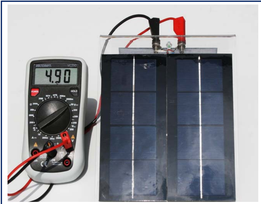
Oben: Das Solarmodul SUSE 4.35, auf der Vorderseite befinden sich 2 Module SUSEmod6, auf der Rückseite erkennt man die 2 Buchsen rot (+) und schwarz (-), dazwischen die grüne LED zur Betriebsanzeige. Das Voltmeter zeigt die Modulspannung 4,9 V an.
