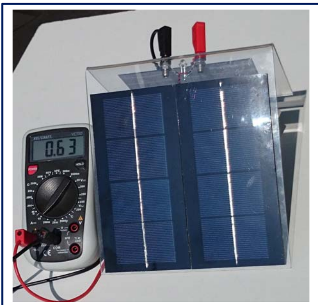
Oben: Das Solarmodul SUSE 4.35, auf der Vorderseite befinden sich 2 Module SUSEmod6, auf der Rückseite erkennt man die 2 Buchsen rot (+) und schwarz (-), dazwischen die grüne LED zur Betriebsanzeige. Das Voltmeter zeigt die Modulspannung 4,9 V an.
