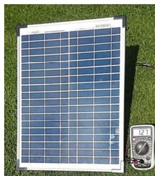
Das **Amperemeter** zeigt den Kurzschlussstrom 1,27 A an.
