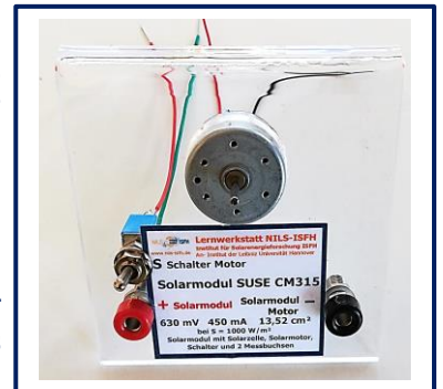
Unten: Vorderseite bestückt mit Aufkleber, Buchsen, Lötösen, Schalter
