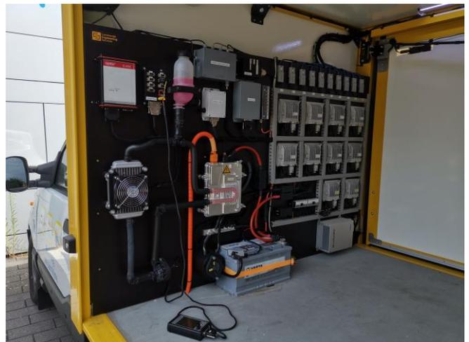
Die **solare Elektronik** im Streetscooter: **Rechts** befinden sich die 10x MPP- Tracker zum Anpassen der Solarmodule an den 12V-Zwischenspeicher- Akku, der unten am Boden steht.
