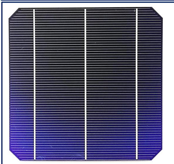
Das Foto zeigt die Vorderseite einer monokristallinen 6-Zoll-Solarzelle, die dunkelblaue Farbe ist die hauchdünne (75 nm!) Antireflexschicht aus Siliziumnitrid  $\text{Si}_3\text{N}_4$ . Die weißen Striche sind elektrische Leiter aus reinem Silber, die breiteren 3 Leiter sind die Busbars zur Abnahme des Stroms, hier werden Drähte angelötet. Die Dicke der Solarzelle ist ca. 0,18 mm, den inneren Aufbau aus vielen Schichten zeigt die Grafik oben links:
