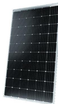
Eine einzige Solarzelle hat nur eine kleine Leistung, für große Leistungen verschaltet man viele Solarzellen in einem stabilen Rahmen, unter hagelfestem Glas, wie es das Foto links zeigt. Hier sind 60 Solarzellen verschaltet.
