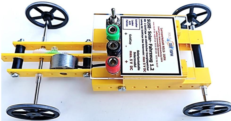
**Links** erkennt man den Solarmotor mit dem 2- stufigen Getriebe an der Vorderachse.
