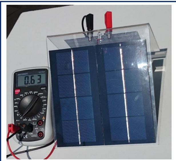
**Links:** Das Amperemeter zeigt den Kurzschlussstrom 0,63 A = 630 mA an
