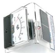
2x Solar- Strahlungsmessgerät SUSE 4.24A
