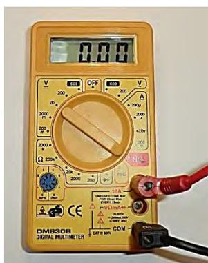
2. Schließe das Messgerät an das Solarmodul an. (Achte auf den richtigen Messbereich, wie es die Abbildung zeigt.)
