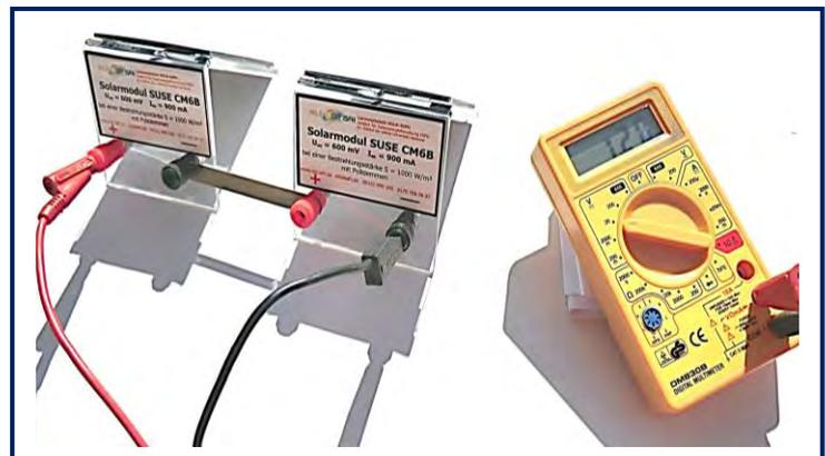
2 Solarmodule SUSE CM6B in Reihenschaltung mit Metallstreifen, das Voltmeter zeigt die Reihenschaltung mit 1,2 V an!
