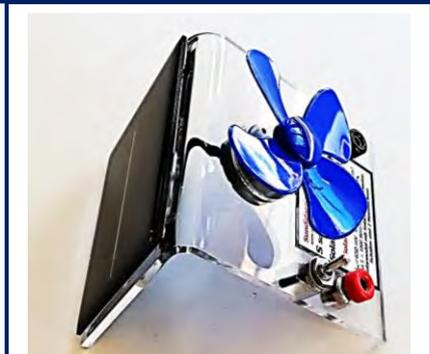
Oben: SUSE CM6MS, links die Solarzelle, rechts Buchsen, Schalter, Motor mit Propeller
