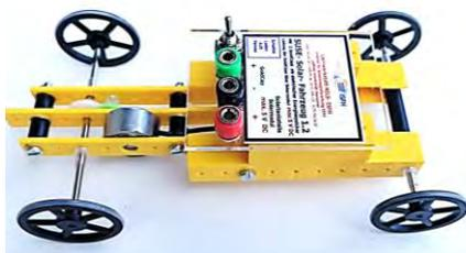
3. Wenn es nicht fährt, verbinde das Solarmodul mit dem GoldCap- Kondensator, der auf dem Solarauto montiert ist. Rote Buchse + und schwarze Buchse -, die grüne Buchse wird nicht benötigt. Achte auf die richtige Polung!
