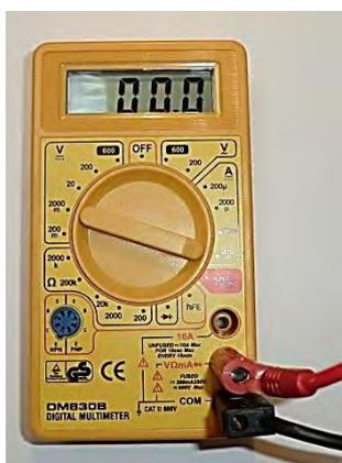
1. Schließe das Messgerät an das Solarmodul an. (Achte auf den richtigen Messbereich, wie es die Abbildung zeigt.)
