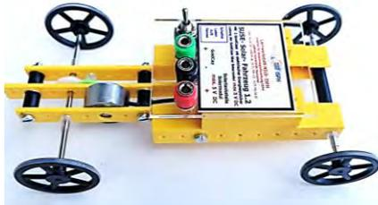
3. Wenn es nicht fährt, verbinde das Solarmodul mit dem Superkondensator, der auf dem Solarauto montiert ist. Rote Buchse + und schwarze Buchse -, die grüne Buchse wird nicht benötigt. Achte auf die richtige Polung!
