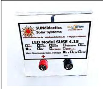
Hier siehst Du das LED- Modul, welches unsichtbares IR- Licht abstrahlt. Das Kästchen IR ist angekreuzt. Unten sind die Anschlussbuchsen für Laborkabel **rot(+)** und schwarz (-).
