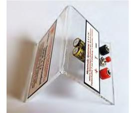
1. 1. Verbinde den Superkondensator mit dem LED-Modul. Achte auf die richtigen Pole. Leuchtet die LED?
