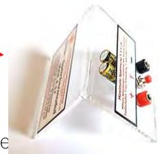
2. Schließe mehrere Solarzellen zusammen und verbinde sie mit einem Superkondensator. Lass alles 2 Minuten lang von der Sonne oder einer Lampe bestrahlen. (Auf dem Foto kannst Du sehen wie es gemacht wird.)
