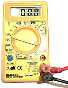
Schließe das LED- Modul SUSE 4.15 mit 2 Kabeln an das Digitale Multimeter an, wie Du es in dem Foto erkennst, stelle den Wahlschalter auf 2000m, wie im Foto!
