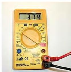
die Kabel so an das Messgerät an, wie du es auf dem Foto kannst. Die andere Seite der Kabel verbinde mit dem Halte nun die Solarzelle ins Licht. Achte auf die richtige des Messbereiches (20V DC). Miss jetzt die Spannung.
