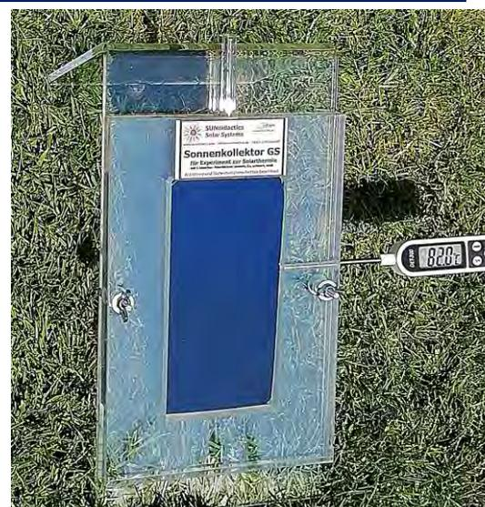
4. Du kannst den Kollektor durch Aufschrauben der 2 Flügelmuttern öffnen und das Absorberblech umdrehen. Bitte das Absorberblech nicht mit bloßen Händen berühren, Handschuhe tragen! weiter auf Seite 2
