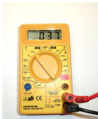
Im linken Bild ist der Messbereich 20V Gleichspannung eingestellt, das Gerät zeigt 0,37 V an. Das schwarze Minuskabel steckt in der Minusbuchse, das rote Pluskabel in der V- Buchse.
