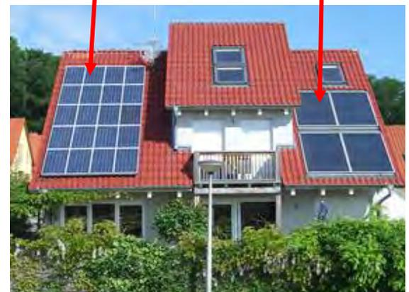
Auf dem Foto rechts siehst Du ein Haus mit 1440 Solarzellen auf dem linken Dach und 4 Sonnenkollektoren auf dem rechten Dach. Wofür werde sie verwendet?
