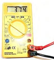
die Kabel so an das Messgerät an, wie du es auf dem Foto kannst. Die andere Seite der Kabel verbinde mit dem Halte nun die Solarzelle ins Licht. Achte auf die richtige des Messbereiches (20V DC). Miss jetzt die Spannung.
