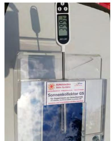
Zum Wechsel der Absorber- Oberfläche Gerät mit den Flügelmuttern öffnen und das Blech umdrehen. **Die Oberflächen nicht mit bloßen Händen berühren, Handschuhe verwenden!**
