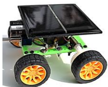
Selbstbau- Solarfahrzeug SUSE Solarfilter turboSC mit Superkondensator 10F als Energiespeicher
