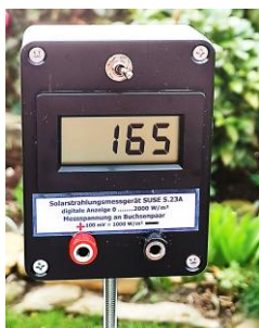
Selbstbau- Bestrahlungsstärke- Messgerät SUSE 5.23A Aktuelle Solar- Bestrahlungsstärke: 165 W/m 2
