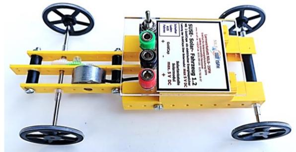
Geeignete Solartankstellen: SUSE 4.3RB, SUSE 4.32 oder SUSE 4.35. Die beiden Speicherkondensatoren 5F befinden sich im Innern des Fahrzeugs unterhalb der Buchsen.
