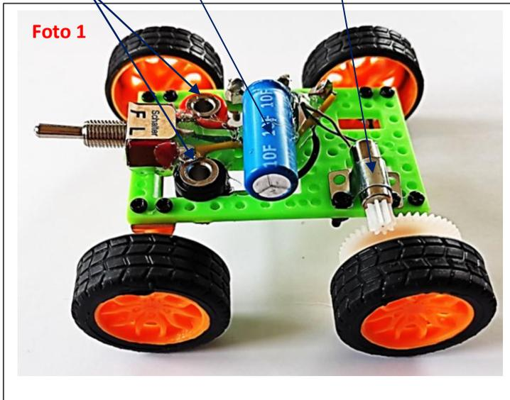
Das **Foto 1** zeigt das E- Auto SUSE Solarflitzer turboSB. Links erkennt man die beiden Ladebuchsen und den Betriebsschalter, in der Mitte befindet sich der Energiespeicher, ein Superkondensator mit 10F Kapazität, rechts der Elektromotor mit Getriebe.
