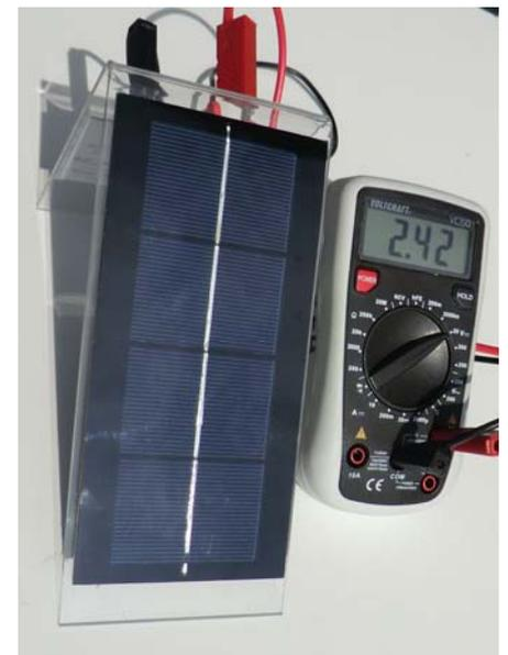
Die **Solartankstelle SUSE 4.34** mit  $U = 2,4 V$  ist für das Solarfahrzeug 1 optimal geeignet.
