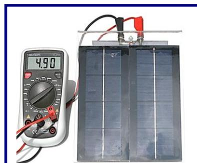
Das Solarfahrzeug 1.2 an der **Solartankstelle** (Solarmodul SUSE 4.35), ein Solarmodul mit 2,5V + 5,0V Ausgangsspannung, 8 Solarzellen in interner Reihenschaltung, ideal zum Laden des Solarfahrzeugs.
