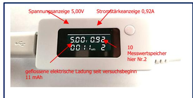
Spannungsanzeige 5,00V    Stromstärkeanzeige 0,92A
