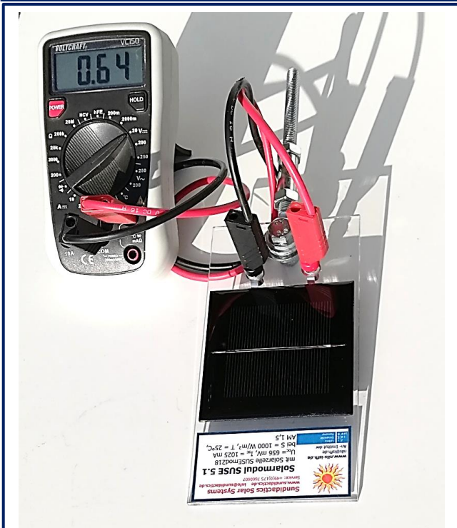
Das Multimeter zeigt Outdoor im Sonnenschein eine Leerlaufspannung von 0,64 V.
