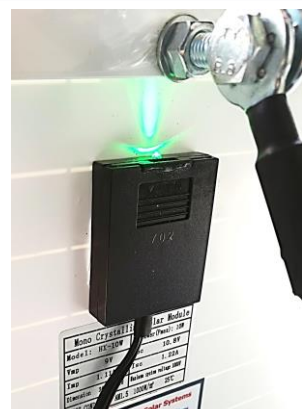
Die grün leuchtende LED an der Anschlussbox zeigt die Betriebsbereitschaft an.
