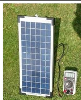
Das **Amperemeter** zeigt den Kurzschlussstrom 0,65 A an.
