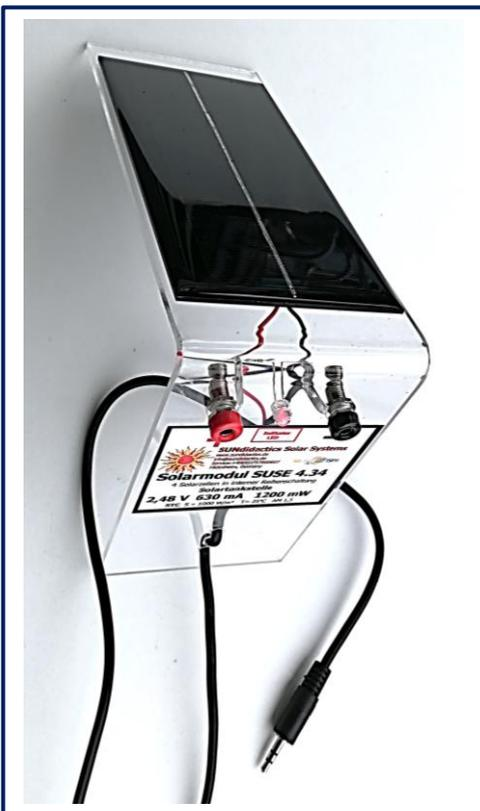
Das Solarmodul **SUSE 4.34** ist ein robustes Modul mit dem Solarmodul SUSEmod 6 mit 4 Solarzellen in interner Reihenschaltung. Die **Modulspannung ist 2,48 V**, der **Kurzschlussstrom 630 mA**, die **Leistung 1,2 W** bei Standard- Test- Bedingungen (Bestrahlungsstärke 1000 W/m<sup>2</sup>, T = 25°C, AM 1,5).
