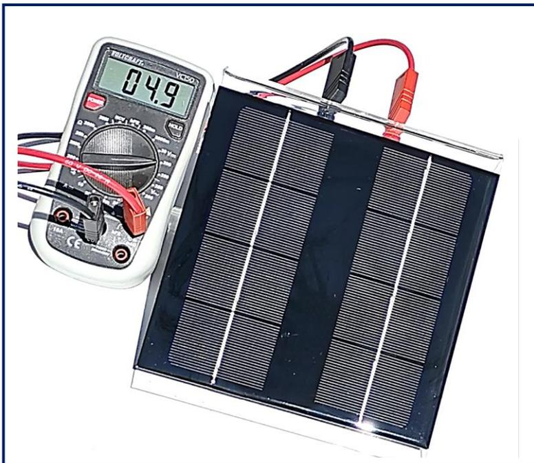
**Oben:** Das Solarmodul SUSE 4.32, auf der Vorderseite befindet sich das Modul SUSEmod12, auf der Rückseite erkennt man die Buchsen rot (+) und schwarz (-), dazwischen die grüne LED zur Betriebsanzeige. Das Voltmeter zeigt die Modulspannung (oben) und den Kurzschlussstrom (unten) an.
