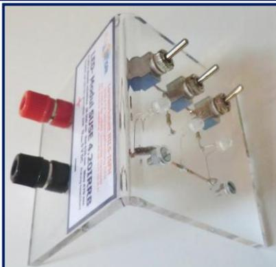
Das LED- Modul SUSE 4.20 IRRB Auf der linken Seite befinden sich die beiden Buchsen und das Typschild, rechts in der Mitte die 3 LED's, oben die 3 Schalter
