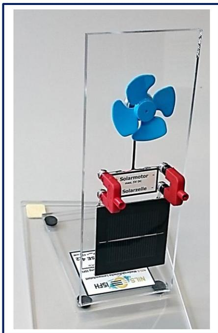
Das nebenstehende Foto zeigt das Solarmodul **SUSE 4.2** auf einem transparenten Plexiglasträger. Seit 2014 wird ein blauer Propeller (Lüfterflügel) eingesetzt, da sich dieser besser für die Generatorexperimente eignet.
