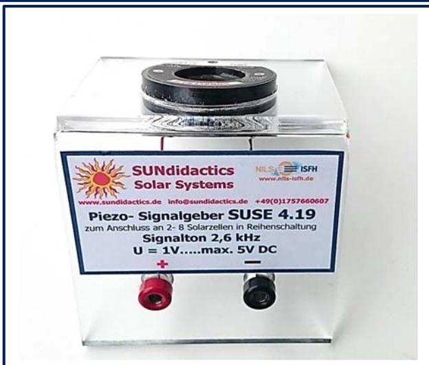
**Oben:** Das Gerät von der Vorderseite, unten die beiden Anschlussbuchsen rot (+) und schwarz (-). Auf der anderen Dachseite befindet sich der Signalgeber.
