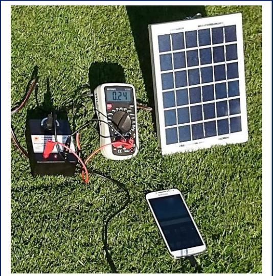
2 Indikator-LEDs zeigen den Betriebszustand an, eine rote Input LED, Output grüne oder blaue LED in den USB- Buchsen. Rechts ist das Input- Buchsenpaar mit roter Buchse (+) und schwarzer Buchse (-)
