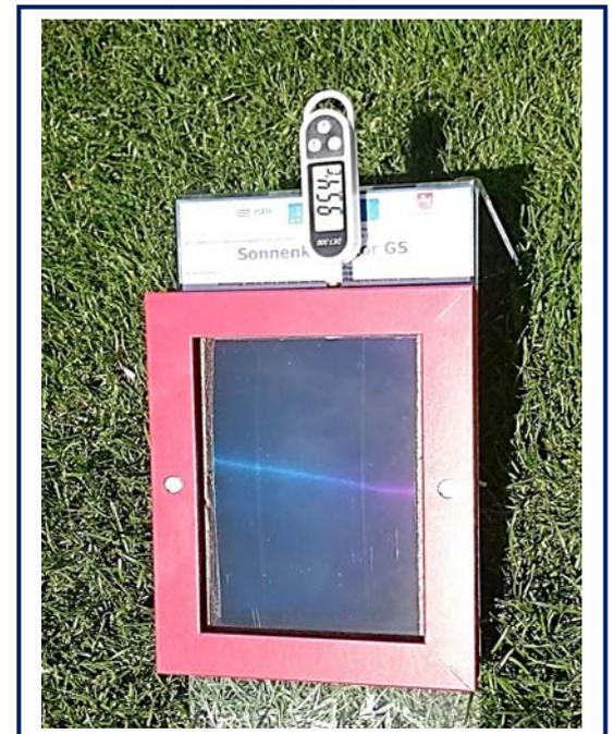
Das Einstichthermometer im Betrieb an einem Sonnenkollektor GS, aktuell zeigt es  $95,4^{\circ}\text{C}$  an. Die Messspitze passt in das Einführungs- Rohr des Kollektors und wird unter den Absorber geschoben. Man erkennt das blau- violette selektive Absorberblech unter der Abdeckscheibe.
