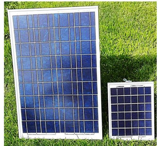
**Foto von einem Versuchsaufbau:** Links das 20 W- Modul SUSE 4.42 mit 36 Zellen, rechts das 5 W- Modul SUSE 4.51 mit 18 Zellen, beide zur Sonne ausgerichtet.
