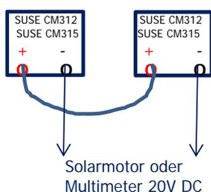
2 Solarmodule SUSE CM 308/312/CM315 werden im Freien zur Sonne ausgerichtet oder im Unterrichtsraum ca. 30 cm vor einen Halogenstrahler 120 W (oder Grundgerät SUSE 4.0) nebeneinander aufgestellt, die Solarzellen zeigen zur Lampe. Die Motoren der beiden Module sind eingeschaltet. Die beiden Pluspole werden verbunden, an den beiden Minuspole wird der Solarmotor oder ein Multimeter im MB 20V DC angeschlossen. Teste die Wirkung der falschen Reihenschaltung und **erstellen eine Erklärung**.
