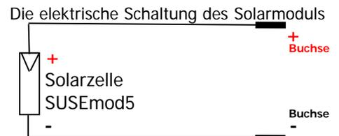
1. Das **Solarmodul SUSE CM308** ist ein **Einsteiger- Solarmodul mit einer hochwertigen Solarzelle SUSEMod5 52mm x 26mm in einem Solarmodul des Formats 60mm x 30mm.**
