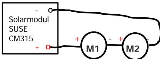
Teste diese Schaltung! Wenn sich die Motoren drehen, kannst Du M3 und M4 in Reihenschaltung ergänzen. Teste auch diese Version!
