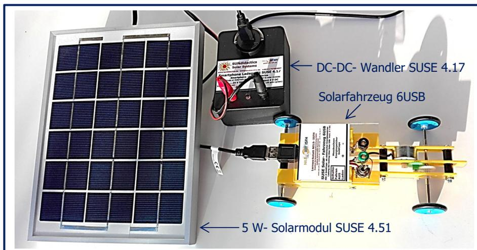
**„Auftanken“ des Solarfahrzeuges 6USB** am 5W- Solarmodul SUSE 4.51 über den DC-DC- Wandler SUSE 4.17 mit USB- Ausgang. Das Ausgangskabel des Solarmoduls (rot- schwarzes Steckerpaar) ist unten in den DC-DC- Wandler eingesteckt, oben ist der USB- Ausgang, der mit einem USB-A-Kabel (2x USB-A-Stecker) mit dem Fahrzeug verbunden wird.
