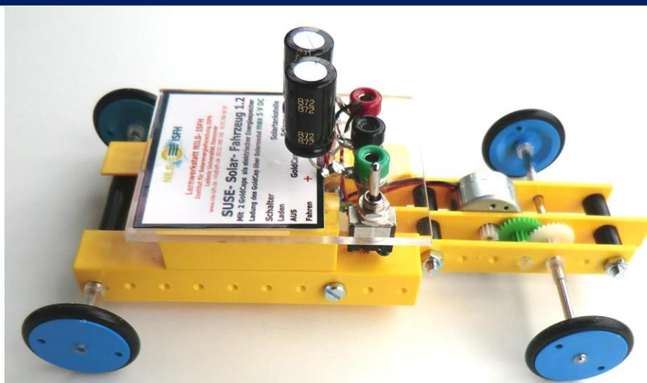
**Vorne** erkennt man den Solarmotor mit dem 2- stufigen Getriebe an der Vorderachse.
