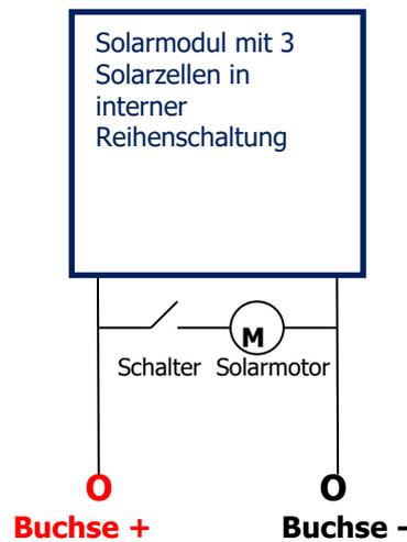
Ist der Motor eingeschaltet, muss sich der Elektromotor im natürlichen Tageslicht oder in der Nähe von Lichtquellen schnell drehen. Das Licht im Innenraum ist sehr schwach und reicht nicht aus.
