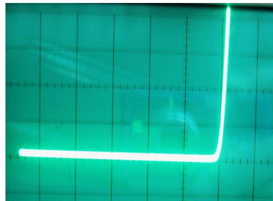
I- U- Kennlinie der IR- LED . Der Kennlinienknick liegt bei ca. 1,1 V. 1 cm in x- Richtung = 1V
