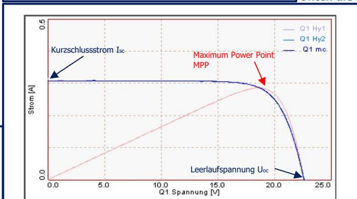
**Die I-U und P(U) Kennlinien des Solarmoduls SUSE 4.51-36**
