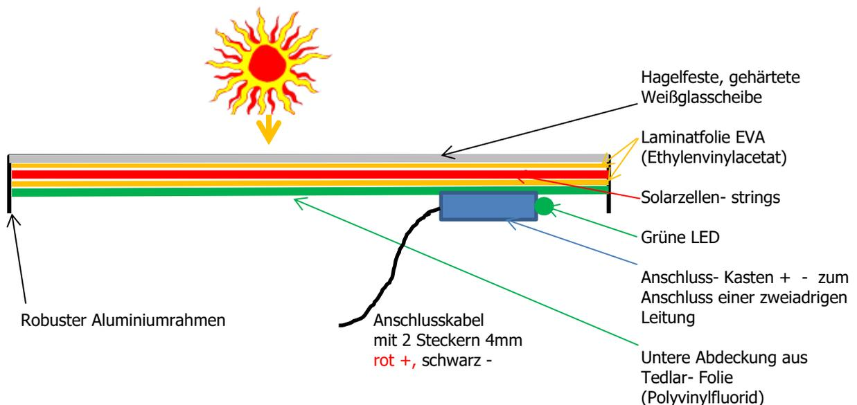
Beim Solarmodul **SUSE 4.51-36** ist im Anschlusskasten ein 1,5 m langes, zweiadriges Anschlusskabel mit 2 Büchelsteckern 4mm **rot (plus)** und schwarz (minus) angelötet, eine grüne LED zeigt die Betriebsbereitschaft an.
