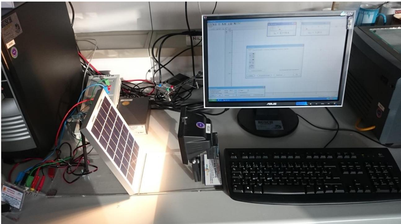
Auf dem Grundgerät SUSE 4.0 mit Halogenstrahler 120 W steht das bestrahlte Solarmodul SUSE 4.51. Ganz links unten steht das Lastmodul SUSE 4.55-36, darüber der Mess- PC. Hinter dem Solarmodul steht das Messinterface CassyLab. Auf dem Bildschirm erkennt man das Menü zur Einstellung der Messparameter. Ganz rechts steht ein Overheadprojektor als Lichtquelle, auf dem das Experiment auch bei höherer Lichtintensität durchgeführt werden kann.
