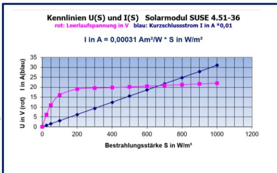
**Die Kennlinien des Moduls: Links die  $U_{oc}$  (S) und  $I_{sc}$  (S)- Kennlinie:**
