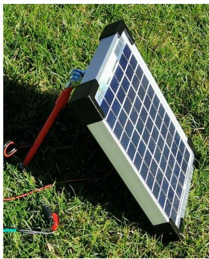
Das **Solarmodul SUSE 4.51-36** ist ein professionelles und sehr robustes Solarmodul mit **36 Solarzellen in interner Reihenschaltung** unter ESG-Solarglas, eingerahmt mit einem stabilen eloxierten Aluminium- Rahmen. Auf der Modulrückseite ist ein verstellbarer Aufsteller angebracht, mit dem das Modul auf dem Boden oder auf einem Tisch stufenlos im optimalen Winkel zum Sonnenstand eingestellt werden kann.
