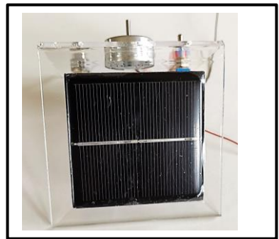
Montage des Solarmoduls
