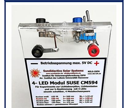
Rote Plusbuchse und Typschild eingebaut
