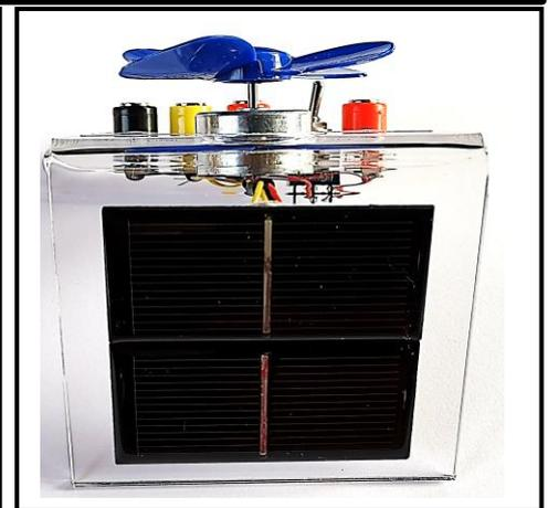
Das Solarmodul SUSE CM320, links die beiden Solarzellen, rechts der Solarmotor mit Propeller, der Schalter und die 4 Messbuchsen
