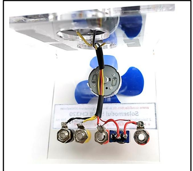
Die Innenseite mit den beiden Schrumpfschlauchröhrchen und den angelöteten Drähten.
