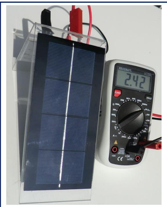
Das **Solarmodul SUSE 4.34** ist ein robustes Modul mit dem Solarmodul SUSEmod 6 mit 4 Solarzellen in interner Reihenschaltung. Die **Modulspannung ist 2,48 V**, der **Kurzschlussstrom 630 mA**, die **Leistung 1,2 W** bei Standard- Test- Bedingungen (Bestrahlungsstärke 1000 W/m<sup>2</sup>, T = 25°C, AM 1,5).
